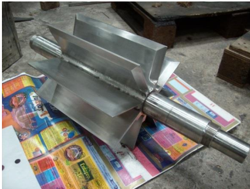
รูปที่ 2.8 ลักษณะชุดใบเปิดแบบไม่สามารถตั้งระยะใบได้รูปที่
