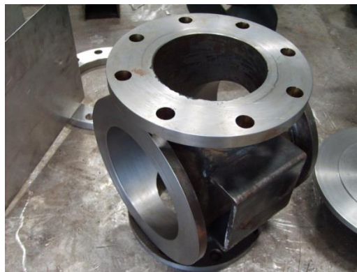
รูปที่ 2.4 ลักษณะปากแบบเปิดโล่ง
