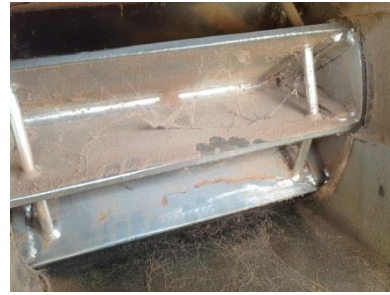
รูปที่ 2.22 ลักษณะโรตารีวาล์วสำหรับวัสดุที่มีลักษณะเป็นเส้นใย
