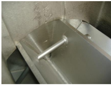
รูปที่ 2.22 ลักษณะโรตารีวาล์วสำหรับวัสดุที่มีลักษณะเป็นเส้นใย
