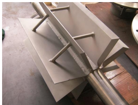
รูปที่ 2.10 ลักษณะชุดใบเปิดแบบตามระหว่างใบ
